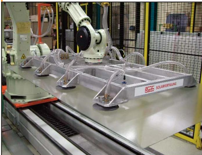
Handhabung der Glasplatten mit hochsensiblen Vakuumbreifer
