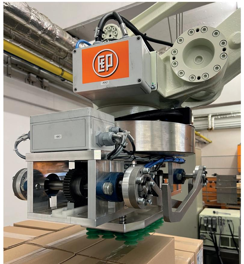
*Gefederte Sauggreifer die Kartons mit Vakuum aufnehmen können*
